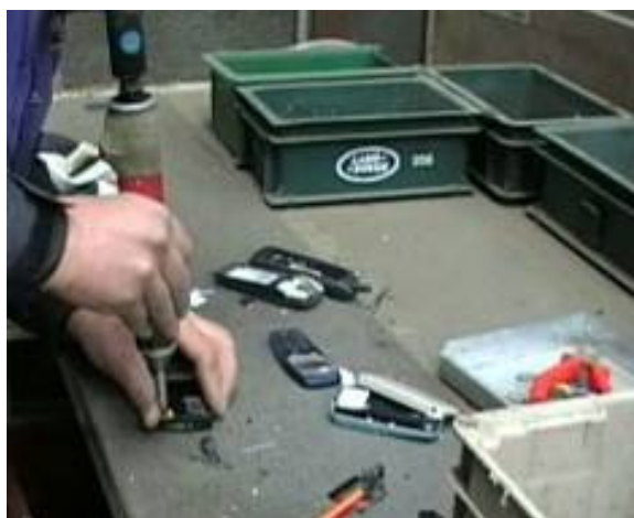
Séparation face avant et face arrière vissées
